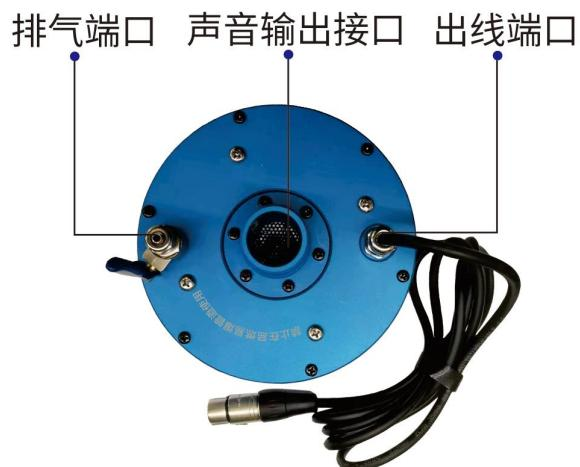
排气端口:用于排气、保护发声振动器
